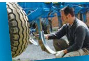
Благодаря системе быстрой смены зубьев культиватор Karat можно без помощи инструмента приспособлять к самым различным условиям эксплуатации.
