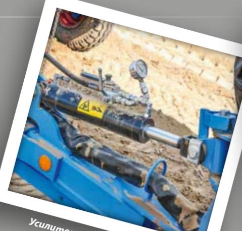
Усилитель тяги тянет верхнюю тягу и переносит нагрузку на заднюю ось.
