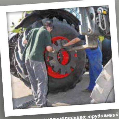
Опасность защемления пальцев: трудоемкий монтаж колесных противовесов.
