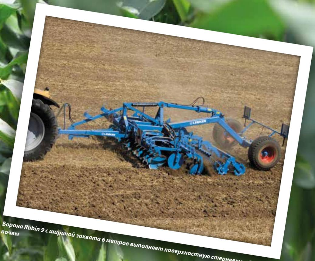
Борона Rubín 9 с шириной захвата 6 метров выполняет поверхностную стерневую обработку почвы
