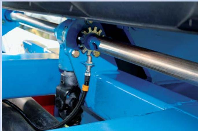
Посредством различных датчиков водитель постоянно получает информацию об актуальном режиме эксплуатации сеялки Янтарь 12. Так, например, датчик вала привода контролирует правильность эксплуатации дозирующих узлов и при возникновении ошибки подает оптический и акустический сигнал водителю о возможных неполадках. Дополнительно все датчики ЛЕМКЕН оснащены интегрированными светодиодами, которые помогают осуществлять быстрый и простой контроль над функциями.
