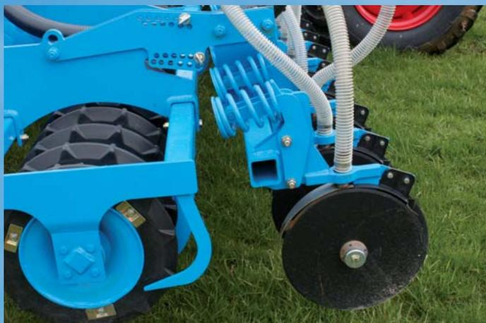
Большие, не требующие обслуживания, двухдисковые сошники для прикорневого внесения удобрений располагаются непосредственно за прикатывающим катком короткой дисковой бороны Гелиодор. Они легко регулируются по глубине при помощи штифта и защищены от перегрузок при помощи пружинного элемента. Благодаря этому гарантируется надежная работа даже на твердых и каменистых почвах.
