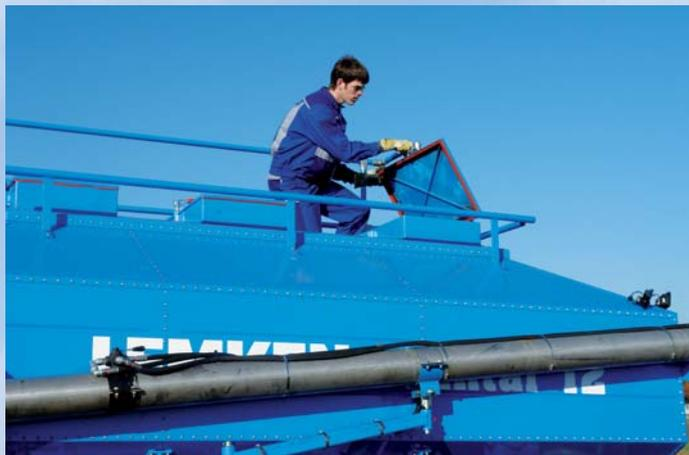
Семенной бункер сеялки Янтарь 12 имеет общий объем 12.200 литров. Он разделен на три части, таким образом, что наряду с семенами независимо друг от друга можно осуществлять хранение, дозировку и транспортировку двух различных видов удобрений. В отличие от дозировки из общего бункера, у сеялки Янтарь 12 не происходит изменения или различия концентрации семян и удобрений.
