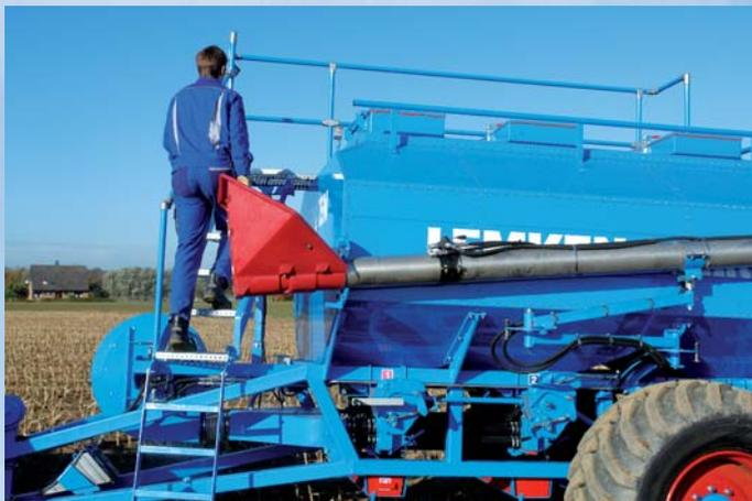
Доступ к семенному бункеру осуществляется просто и безопасно по нескольким ступеням с удобными поручнями. Через весь бункер проходит широкий помост, который также обеспечивает безопасный доступ к семенному бункеру. Таким образом, очистка при смене семенного материала происходит быстро. Раздельные крышки бункера открываются очень удобно. При работе они надежно закрывают бункер и защищают семена от пыли и загрязнений.
