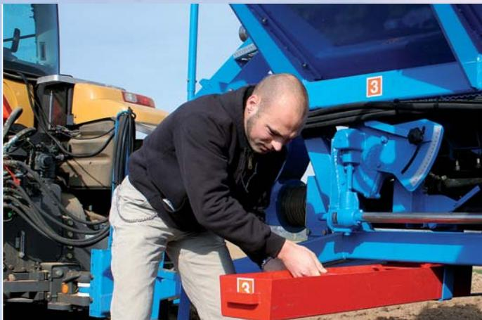
Для регулировки нормы высева выдвигаются легкодоступные калибровочные ящики и открываются крышки дозирующих узлов. После открытия заслонок дозирующих узлов семена или удобрения попадают непосредственно в ящик, где производится их взвешивание. Регулировка редуктора осуществляется при помощи хорошо читаемой шкалы, расположенной по ту же сторону орудия. Фирма ЛЕМКЕН внесла свой конкретный вклад в простоту управления и комфорт обслуживания.
