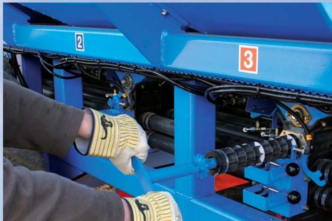
Для того, чтобы наилучшим образом быть готовым к применению различного посевного материала, есть возможность быстрой и простой замены высевных валов. Таким образом, например, при посеве рапса, с небольшой нормой высева и мелкими семенами при применении высевного вала для мелкосеменных культур достигается такое же хорошее продольное распределение семян, как и при применении высевного вала для более крупных семян, таких как ячмень, пшеница, рожь и т.д.
