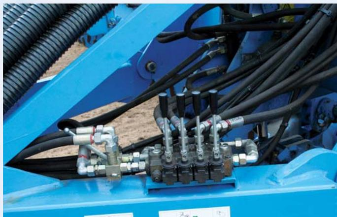
Для обеспечения управления на краю поля, посевная комбинация требует наличия трех гидровыходов двойного действия. Таким образом, следоуказатели могут приводиться в действие независимо от функции подъема секций Гелиодора и подъема сошников бруса. Четвертый гидровыход обеспечивает по выбору работу пневмотурбины или загрузочного шнека.
