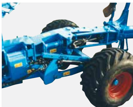
Шарнирное соединение рамы
