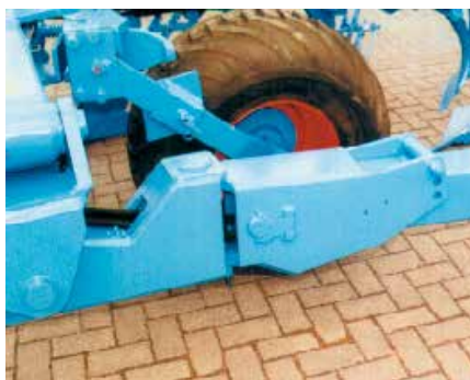
Простая регулировка точки тяги
